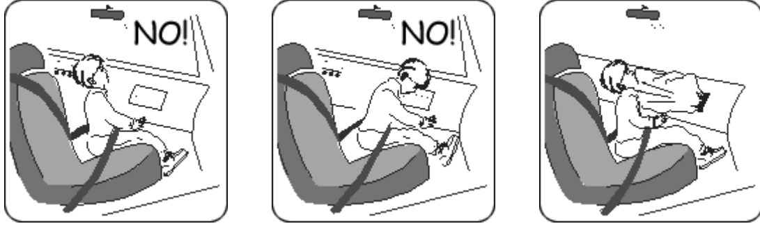
Şekil 1: Önde oturtulmaması gereken çocukta hava yastığına bağlı yaralanma mekanizması.
