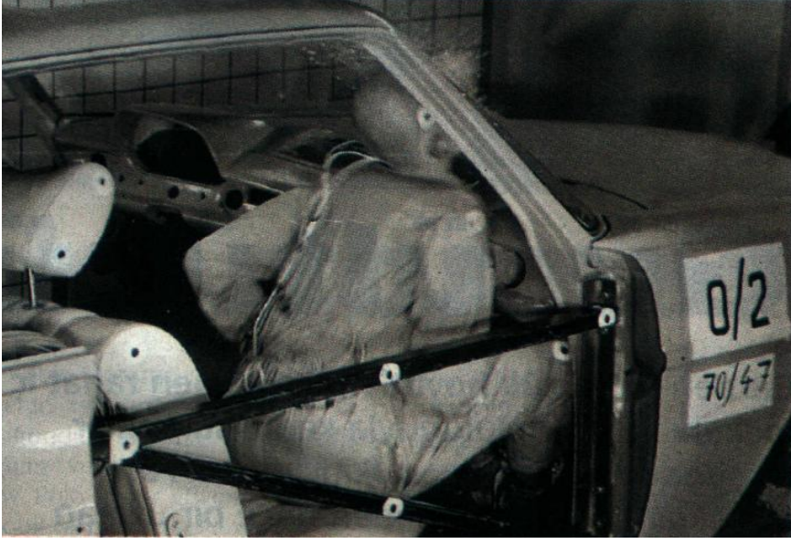
Resim 1: Emniyet kemeri takmadan önde oturanda ön konsola ve ön cama çarpma sonucu yaralanma.
