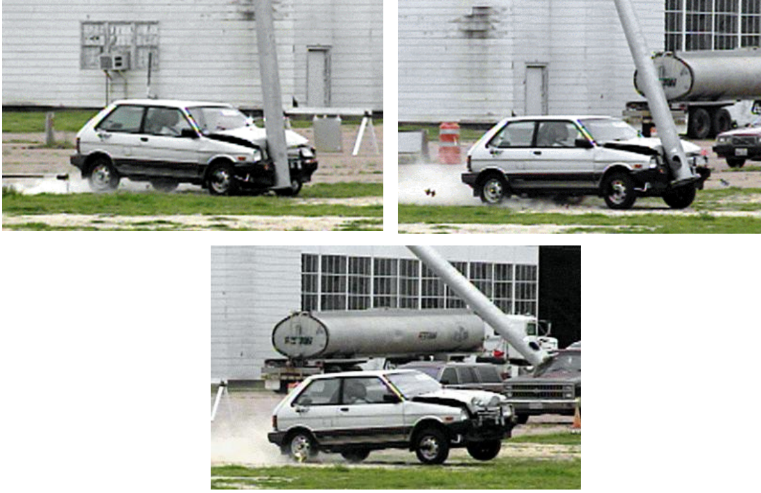
Şekil 3. Kırılabilir Direklerin Davranışının Çarpışma Testi Kullanılarak İncelenmesi
