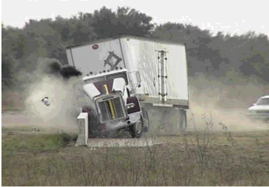
Şekil 6. Betonarme Bariyerin Ağır Vasıta Çarpması Durumunda Davranışının İncelenmesi
